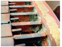
Broken rotor bar
